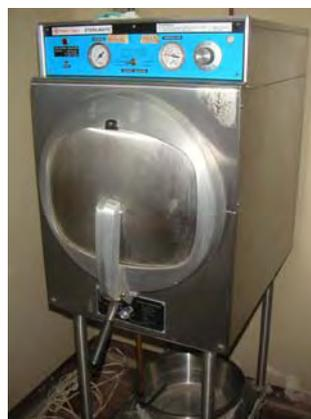
写真4：母子保健診療所で使用されている高圧蒸気滅菌器 (本文 p. 20)
