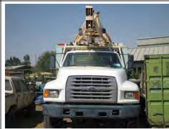
写真-10: 現有のサービスリグ。UNICEF により約 10 年前に供与されたが、モデルが古くスペアパーツの調達が困難となっている。
