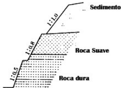
Figura 2.5 Ejemplo de la Pendiente en Talud de Corte
