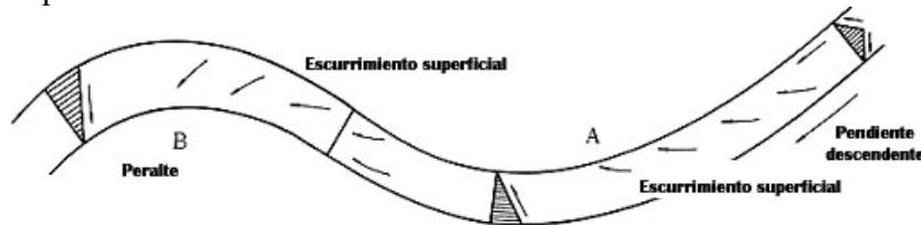
Figura 3.3 Concentración de Agua en la Superficie de una Sección Curva
