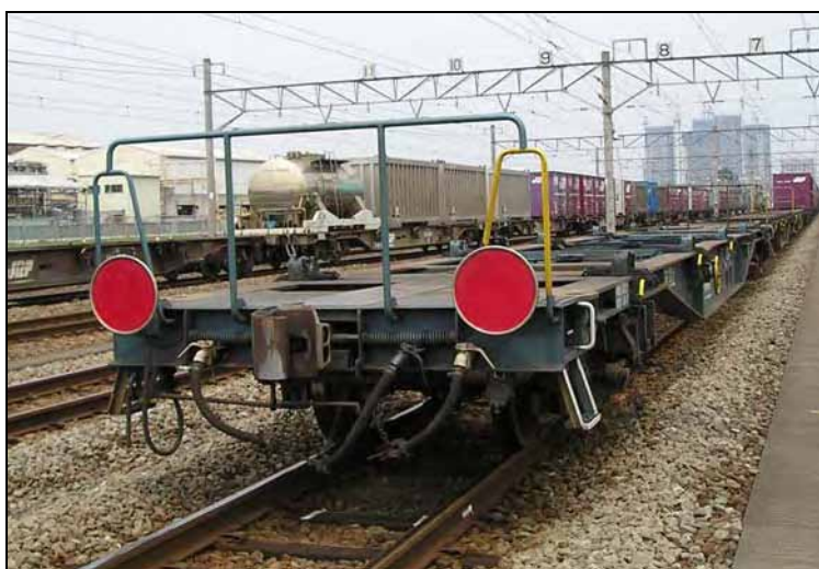
図 9-4 緩急車連結を省略し、代替として反射型尾灯をつけたコンテナ列車(日本)
