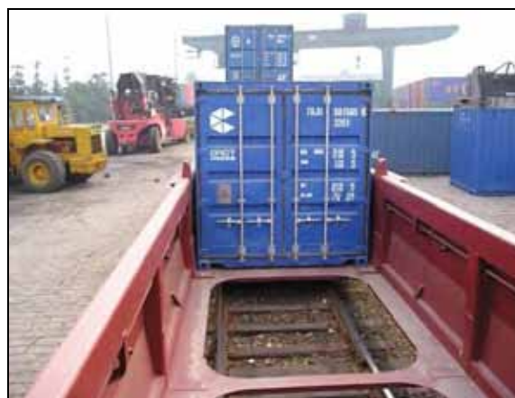
写真 5-2 ウェルタイプ貨車の内部構造(上海)
