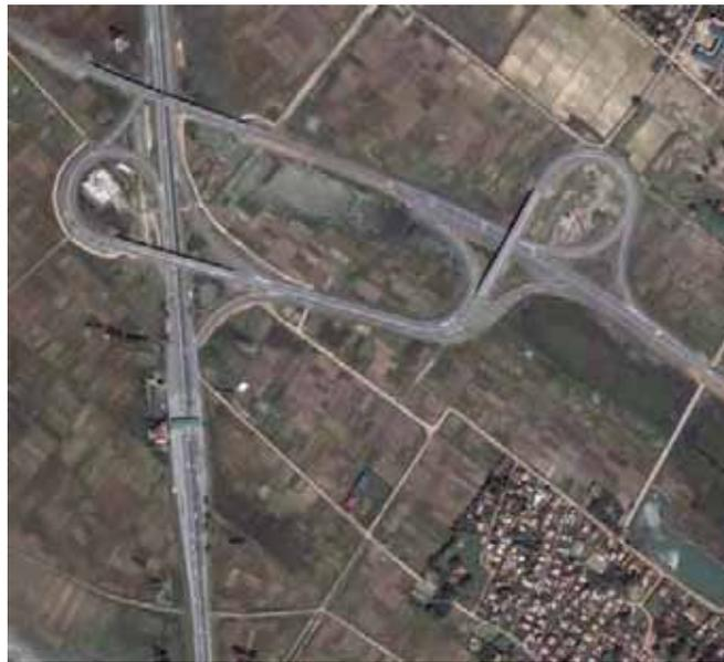
写真2-5 ノイバイ国際空港から、ハノイ市街へ向かうハイウェイの連結等施設本線上は4車線だが、料金所部では片側4ブース×2となっている。
