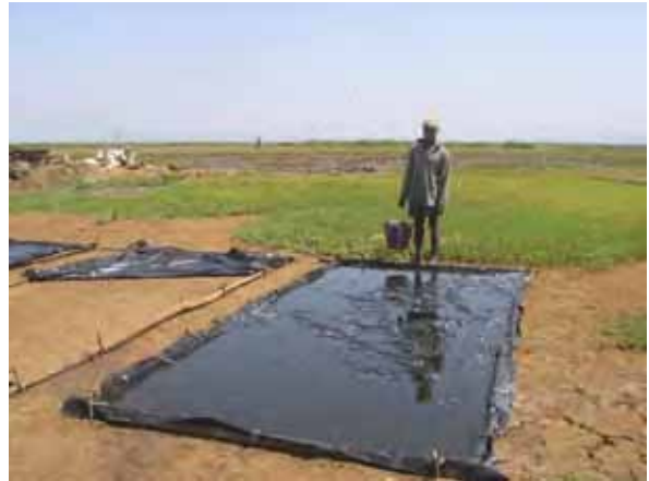
ビニールシートでの製塩方法
