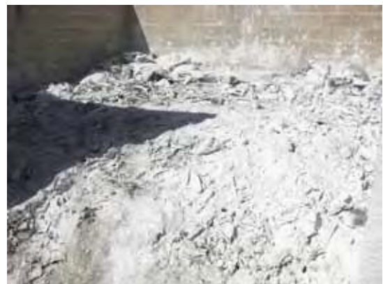
ホムン市の最終処分場。消石灰で動物の死体を処理する。
