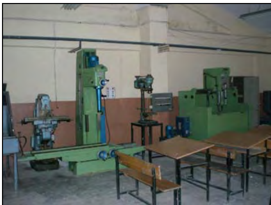
機械加工実習室（ワン校） 立てフライス盤、ボール盤、万能研削盤等
