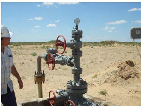
(Закачка попутных вод в пласт)
