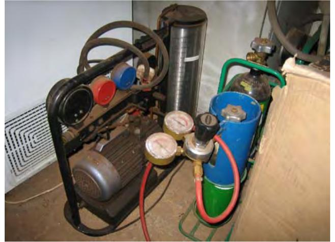
写真14 保健省UNEPIワークショップで使用されている冷蔵庫用冷媒充填器
