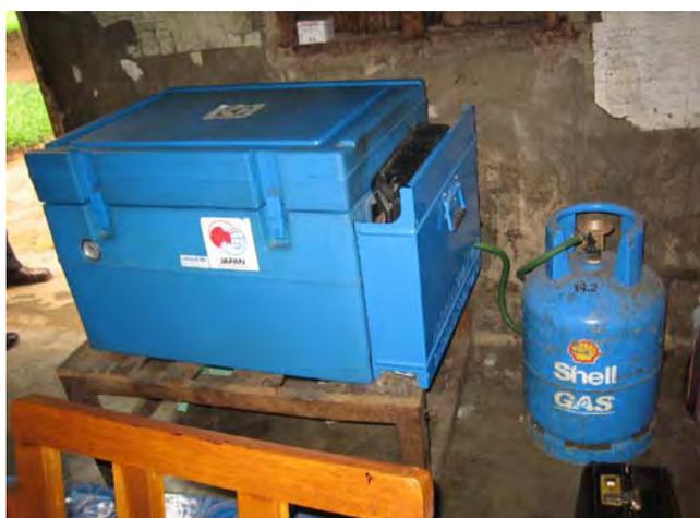
写真5 イガンガ県ブリャンシメ保健センターIIのガス式冷蔵庫(正常稼動中)(盗難防止のため、常に人の居る自宅に保管)
