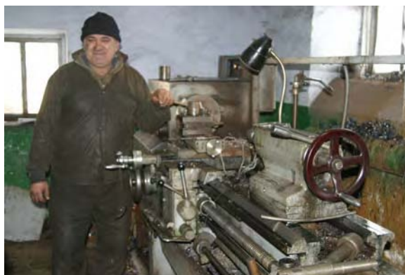
写真-12：農村部の農業機械整備工場。旧集団農場付属の整備工場から購入した工作機械で、製造後 20 年以上経つ。精度は低いが稼動している。
