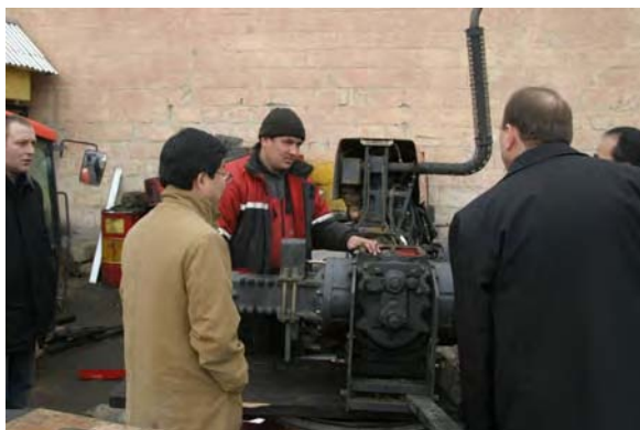
写真-9：2KRで調達されたトラクターのギアボックスを修理中の Agrofermotech 社（農業機械ディーラー）の技術者（写真中央）。「モ」国では農業機械の修理技術を習得した技術者が不足している。
