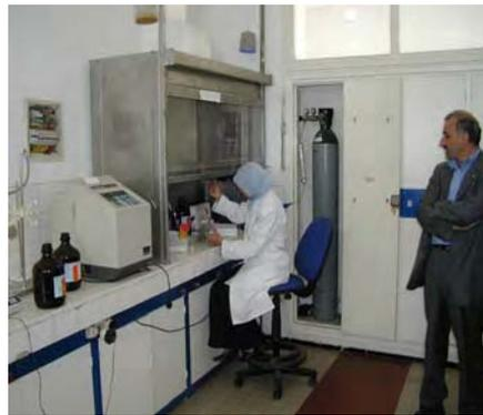
化学研究室：卓上ドラフトチャンバによる実験、ガスボンベが室内設置されており危険な状態にある。
