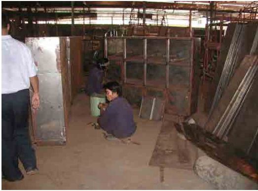
鉄製ロッカーの製作
