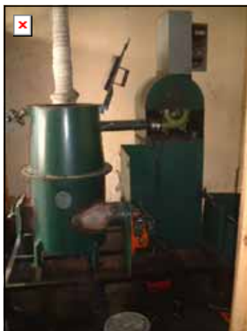
ペカロンガン県保健局に設置してある焼却炉 県内の予防接種キャンペーンで使用されたAD注射器は 県保健局に集められ、まとめてここで焼却処理される。
