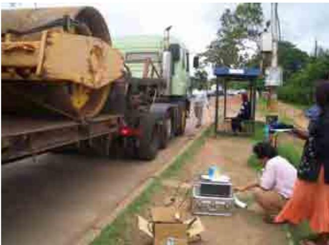
写真-2.22 軸重調査の実施状況。一軸ずつ計測用マットに車輪を設置して軸重を計測する。ブランタイヤ市では、市内に入る前に重量計(Weight Bridge)にて過積載の取り締まりを行っている、過積載車両に対して罰金を科すのみで、積荷を減量させる等の措置は行っていないため、舗装の劣化が設計よりも早い。また、ブランタイヤ市から市外に出る車両の取り締まりも課題である。
