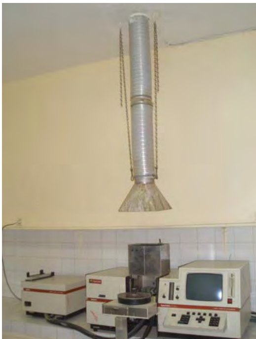
原子吸光分析装置（1992年にEUにより 供与。現在、故障及び備品入手不可のため、 使用不能）
