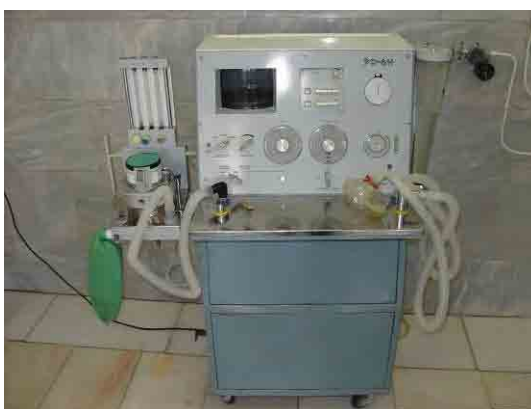
写真-5: 本館 6F 大手術室の故障した旧ソ連製の麻酔器 (1982年製)。麻酔ガス・酸素の混合弁が不良。内蔵の人工呼吸器のベローズが破損し使えない。
