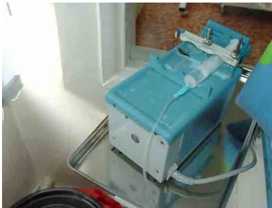
写真-3: 本館 3F 第一産科新生児ユニットの旧ソ連製シリンジポンプ (1988年製)。吐出量調整モーターの不具合があり、薬液の微量調整が困難となっている。
