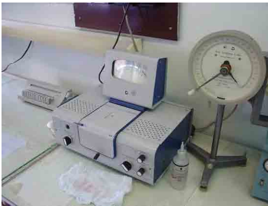
写真-9：別館 2F 臨床検査室の旧ソ連製分光光度計（1977 年製）。メーカーとの接触ができないため、光源のタングステン球の交換部品の供給ができない。早晚、故障停止の状況になる。
