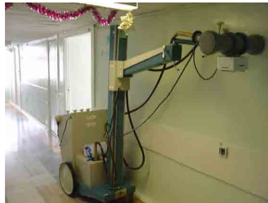
写真-4: 本館 5F 成人 ICU 前の廊下の旧ソ連製移動式 X 線装置 (1982年製)。管球の劣化、X 線発生装置の劣化により設定した量の爆射ができず、不鮮明な画像しか得られない。
