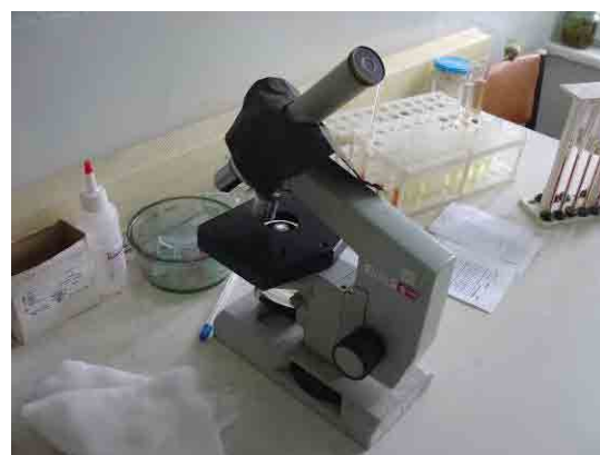
写真-6: 別館 2F クリニカル検査室の旧東ドイツ製単眼顕微鏡 (1977年製)。反射鏡を使っているため、光量が少なく鮮明な視野が得にくい。曇天・夜間の顕微鏡検査では蛍光灯の灯を利用している。
