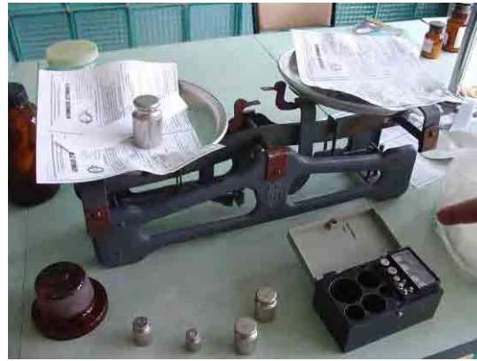
写真-8：別館 2F 薬局の旧ソ連製天秤（1987 年製）。分銅を使った釣合い天秤で試薬の調査を行っているがmg 単位の計量ができない。
