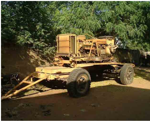
車両搭載型ロシア製高圧コンプレッサー(1994年製)
