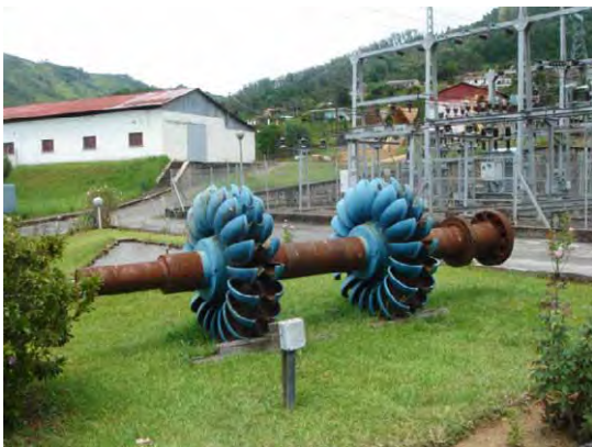
(Mandraka 水力発電所:リハビリテーションで 交換済みのペルトン水車)
