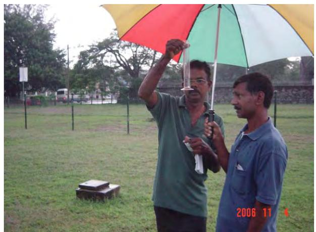
貯水式雨量計の雨量計測状況
