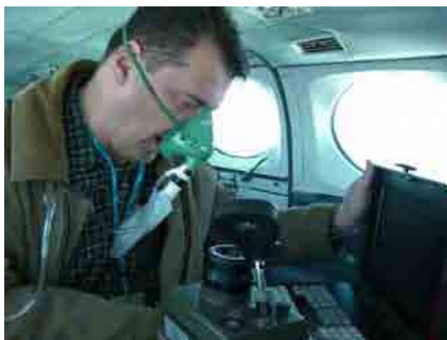
航空カメラ「RC-30」を操作する撮影担当者 （高度:26,000ft ポトゴリツァ上空 撮影縮尺: 1/40,000）
