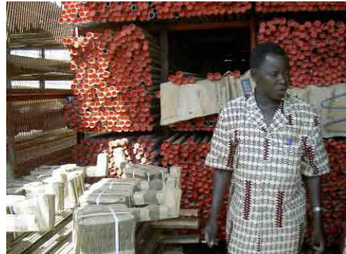
写真-26 ハンドポンプ製造販売会社の保管庫 DIAFA ハンドポンプと India ハンドポンプを製造販売して いる Diacfa 社の部品保管庫。写真は揚水管。
