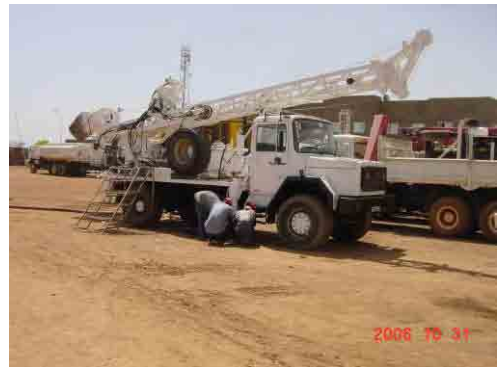
写真-28 民間井戸掘削会社の井戸掘削リグ Foraafric International 社保有のフランス Foraco 社製井 戸掘削リグ、同社はこのようなリグを 8 台保有。
