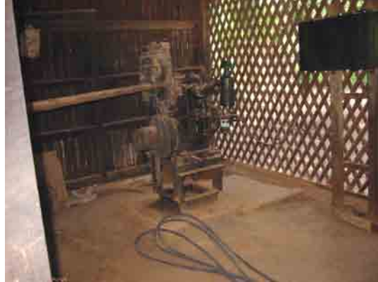
エンジンとモノポンプが老朽化して使えなくなった深井戸 (Chauk Township in Magway)
