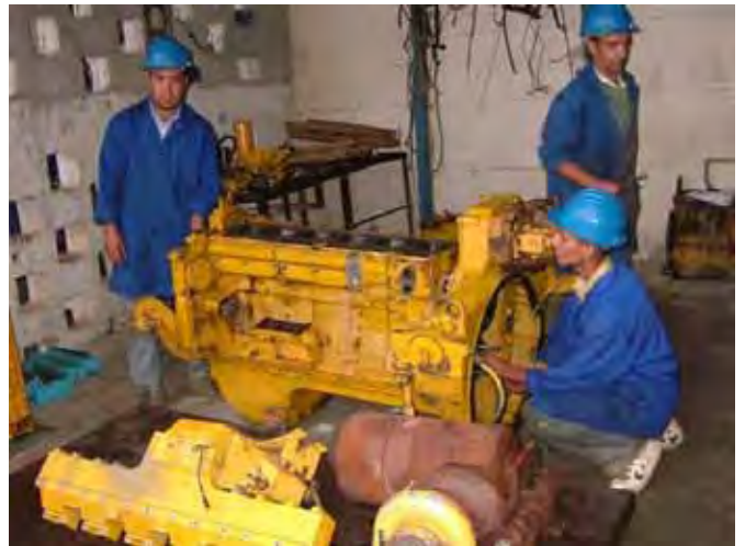
【中央機材保管所：ラバト】 エンジンのオーバーホール作業
