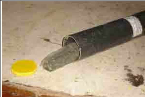
第一管区本部ボーリングより 採取された不攪乱試料
