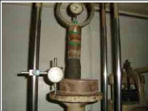
一軸圧縮試験実施状況
