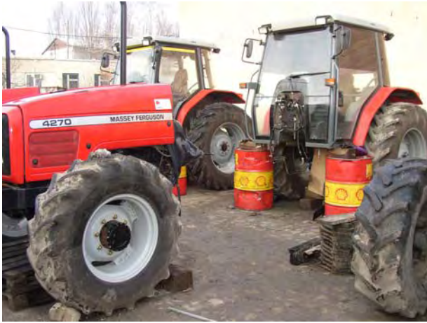
写真-7 <PIU事務所裏のワークショップ> PIU事務所裏ワークショップにて2000年度に供与された英国製(Massey Ferguson)の乗用トラクターのエンジンをはずしての整備が現地ディーラーにより実施されていた。
