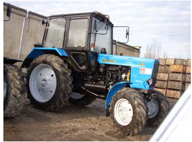
写真-8 <ベラルーシ製乗用トラクター> 見返り資金を活用して調達、販売されているベラルーシ製MTZ 80馬力乗用トラクター。PIU事務所裏から出荷する前の様子。
