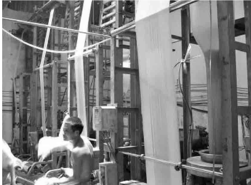
写真2-8 クラフトヴィレッジにおける再生プラスチック袋の製造
