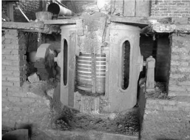
写真2-12 クラフトヴィレッジにおける鉄の溶解炉
