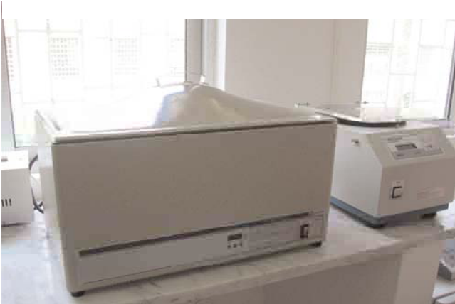
ルアンダ医療専門学校：同上（ウォーターバス、卓上遠心器）
