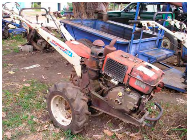
写真14 Kpong灌漑プロジェクト地区の農業組合 同組合で所有の2KRにて購入した耕運機の1つ。多くの農家が 使用するので、激しく消耗しており、現在修理中である。
