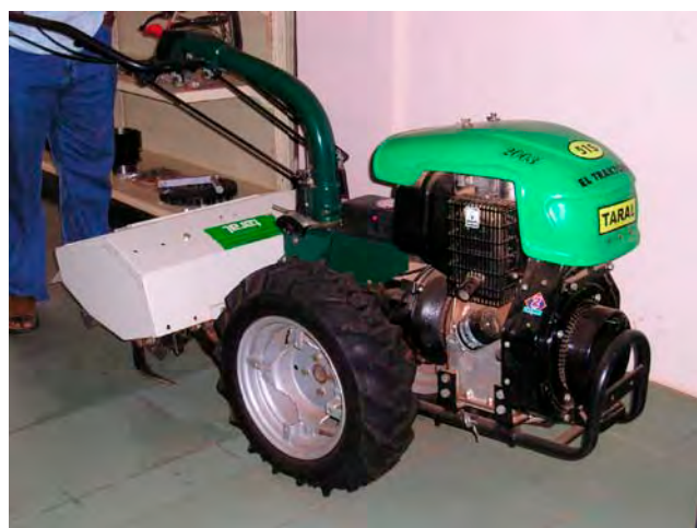
写真12 Agrimat Limited 農業資機材店 同店では最近耕運機も取り扱い始めた。なお、灌漑用ポンプのエンジンは耕運機にも使用可能。
