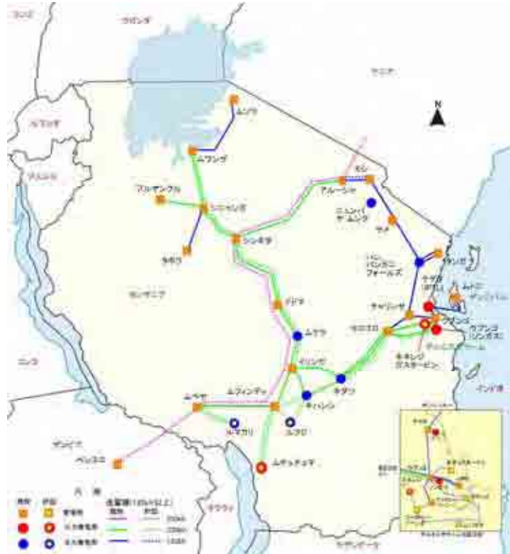
図 1-1-2.1 タンザニア国 電力系統図
