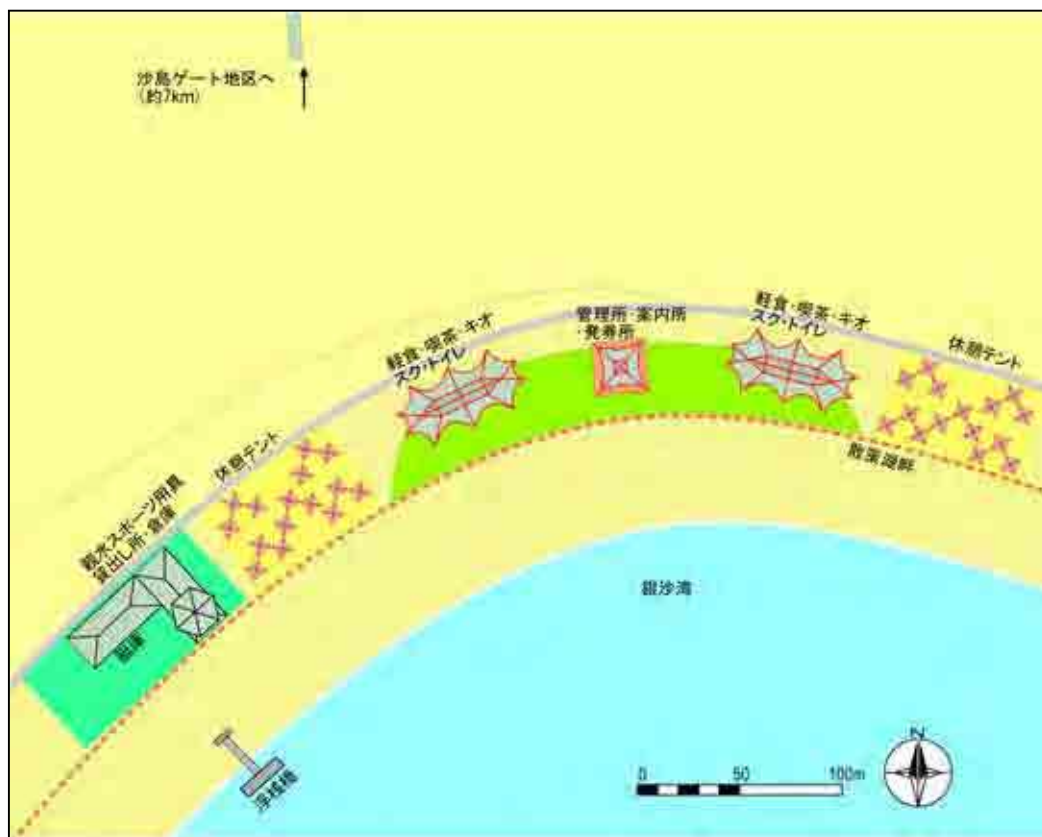
図 16.2.4 砂浜・水上レクリエーション地区概略設計
