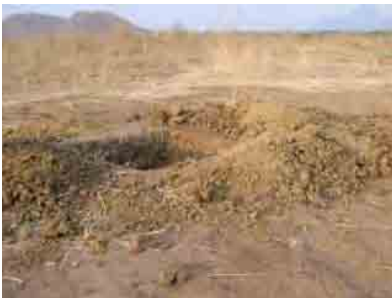
地盤調査の一環として行われた、サイト内での試掘の様子。
