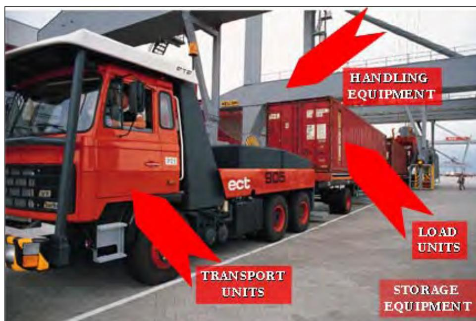
図 9.2 インターモーダル輸送を効率化する設備・機器
