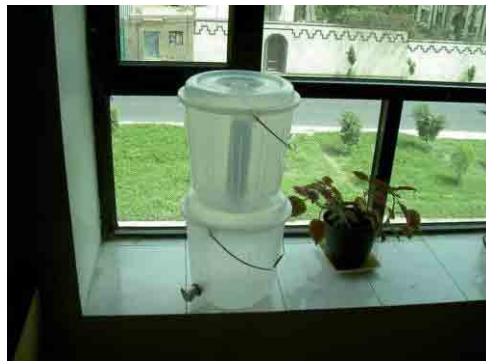
写真-44 家庭用浄水器（セラミックフィルター） PWP と SFD は、伝統的な雨水溜めや池の水を各家庭でセラミックフィルターにより浄化する事を推奨している。価格は 1200 リアル（700 円）。
