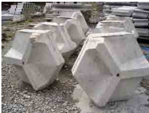
焼酎粕とコンクリートで作成したトコブシ用人工魚礁 魚礁の大きさは一つ 42cm x 49cm x 25cm
