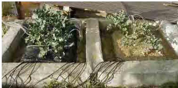
検証実験に用いた排水型ライシメータ
