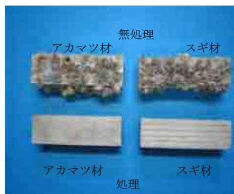
キトサン金属複合体で処理したアカマツとスギ材を、3ヶ月間海中浸漬したもの。無処理材はフナクイムシとフジツボによる汚損が激しく、処理材は被害を受けていない。
