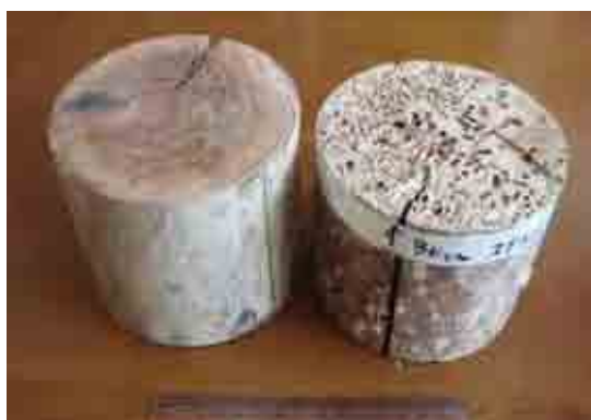
CCC 処理のスギ材を1年間海中浸漬したもの
