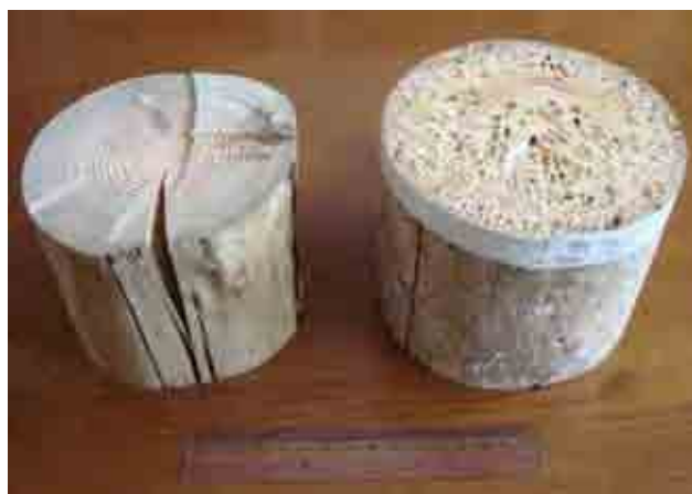
CCC 処理のマツ材を1年間海中浸漬したもの
