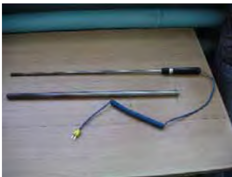
Мэдрэгчтэй термометр ба хамгаалагч хоолой Cap (SUS316)
