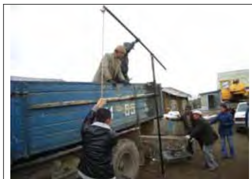
Хүнд жинтэй хаягдал өргөж ачих төхөөрөмж
