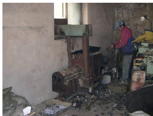
<RDF түлш үйлдвэрлэх> RDF түлшийг Монголд, дотоодын нөөц бололцоог ашиглан үйлдвэрлэв. Хуванцар болон цаасан төрлийн хог хаягдлыг хольж халаасны дараа шахах төхөөрөмжөөр хэвэнд оруулав.
