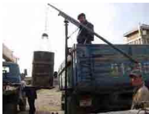
<Өргөх төхөөрөмж> Өргөх төхөөрөмж нь хөшүүргийн хүчний зарчимын дагуу ажиллах ба хогны машины ачигч нарын үнс мэт хүнд жинтэй хог хаягдлыг ачих ажлыг хөнгөвчилдөг.
