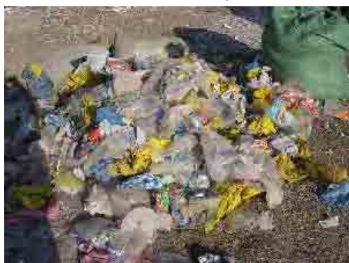
< RDF түлшийн түүхий эд> Хуванцар төрлийн хог хаягдлаар RDF түлш үйлдвэрлэдэг. Түүхий эд болдог бас нэг зүйл бол цаасан төрлийн хог хаягдал. Хүнсний хог хаягдал ашиглахад тэдгээр нь ялзарч RDF-ийг тогтворгүй болгодог тул RDF түлшийн түүхий эд болгон ашигладаггүй.
