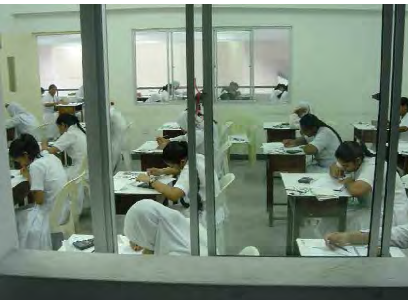
写真-6 : アミニヤ女子中学校 教室が不足しているため、別な用途の部屋を教室として転用している。外部に面した窓が無く採光、通風が不十分。一日中蛍光灯を点灯している。
