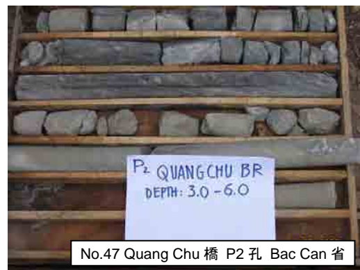
地質調査結果：支持層が浅く、直接基礎が多い
