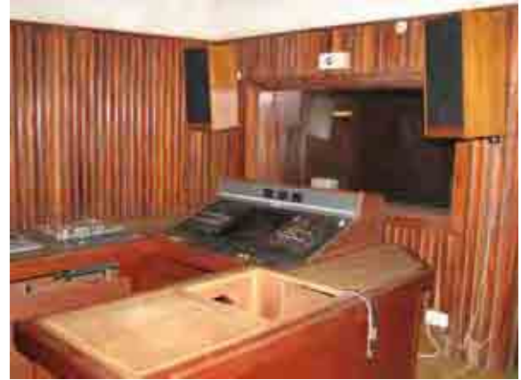
UBC 本部 / プロダクションスタジオコントロール室 音声ミキサーとオープンリールテープレコーダーが残っているが、老朽化のため使用不可能となっている。
