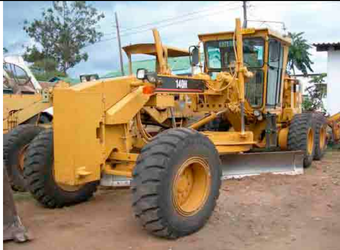
ブランタイヤ市が道路維持管理のため保有するモーターグレーダー（これ以外の車両はほとんど使用不可）。
