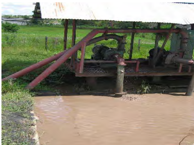
写真 5-2-3 ジグ選別用水循環使用設備
