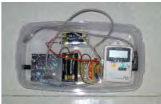
写真 6-1-10 電動機運転検知機
