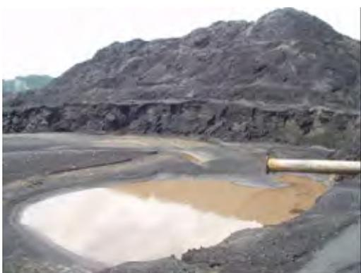
写真1 .セッティングポンドに野積みされている石炭スラッジ（微粉炭）
