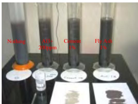
写真 5 -1 沈降試験（開始）
