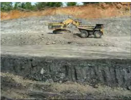
写真3 .炭層上部のクリーニング作業中、上部のダーティコールを除去
