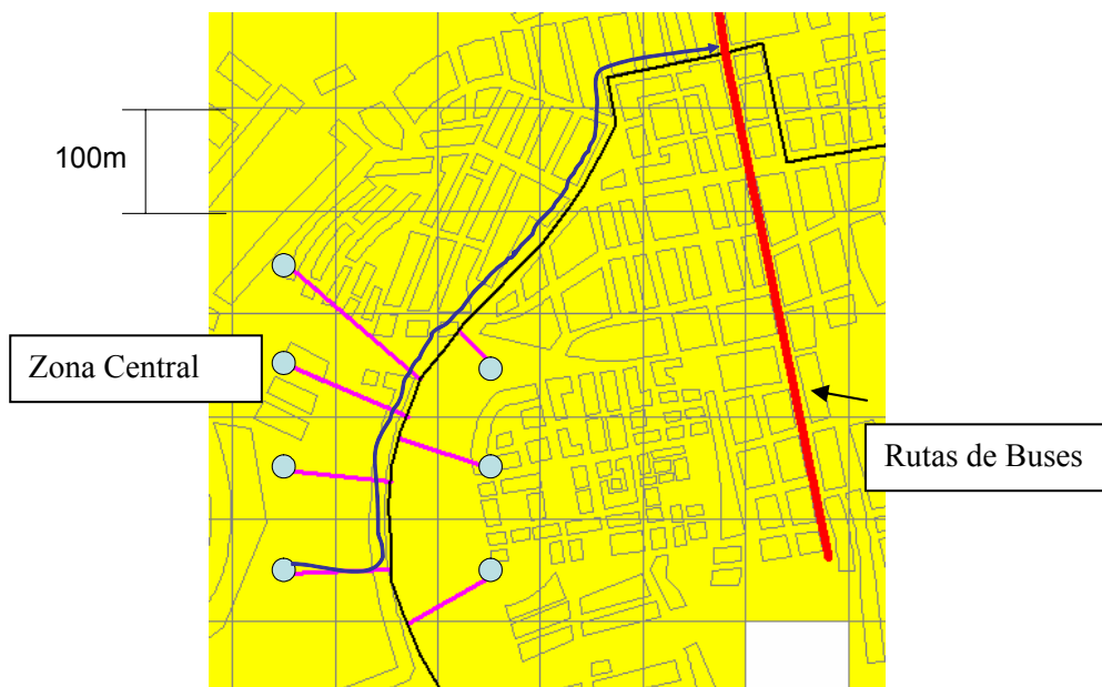
Figura 13.4-13 Distancia a Pie desde el Hogar (Zona Centroide) hasta el Paradero de Buses
