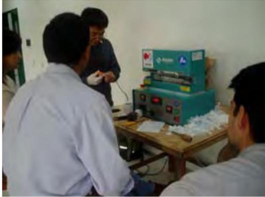
Dispositivo de teste da selagem a quente
