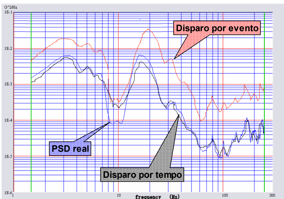
Figura 4-5 Diferença de PSD conforme método de medição
