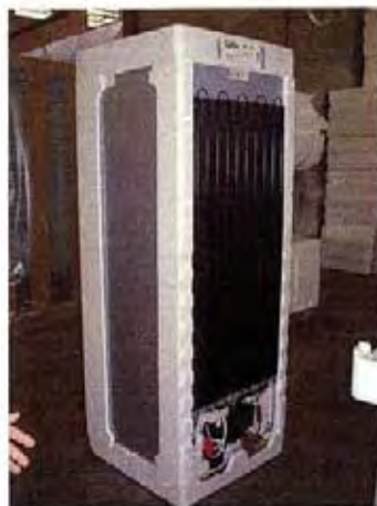
Mejoramiento del embalaje externo de una heladera Vista del embalaje mejorado, antes de su envoltura con film contraible
